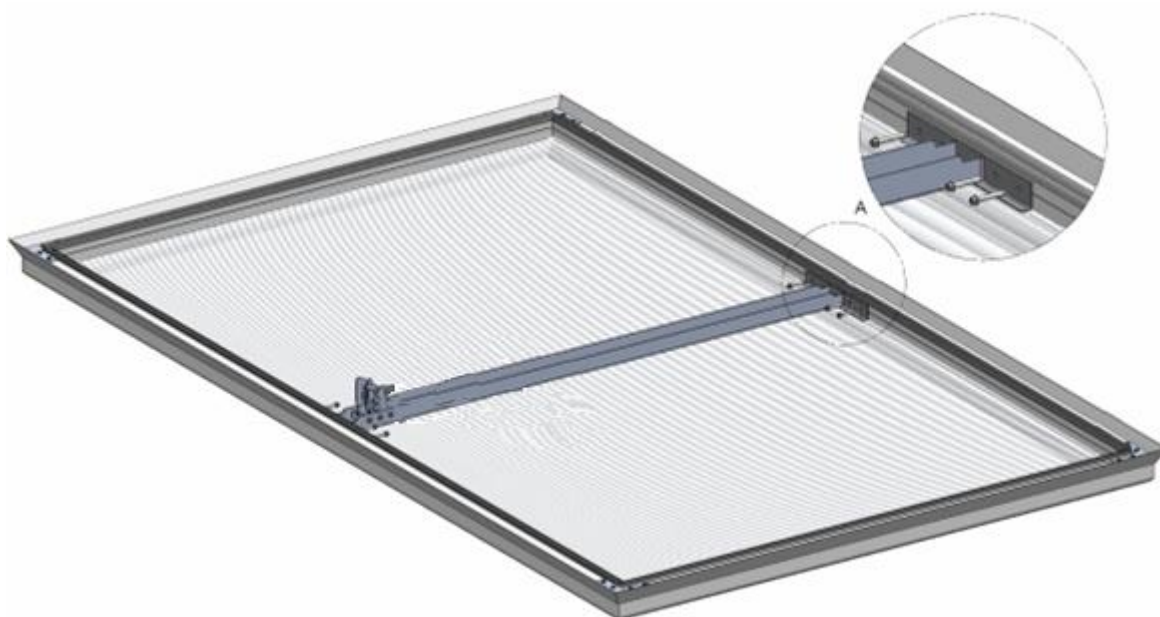
Rys. 16. Montaż trawersu skrzydła.
